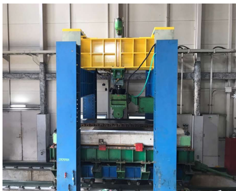
写真-2 輪荷重走行試験機の外観
