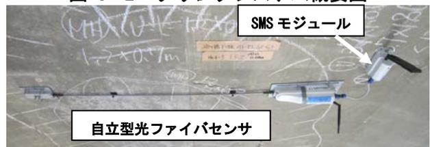
写真-2 センサ設置状況
