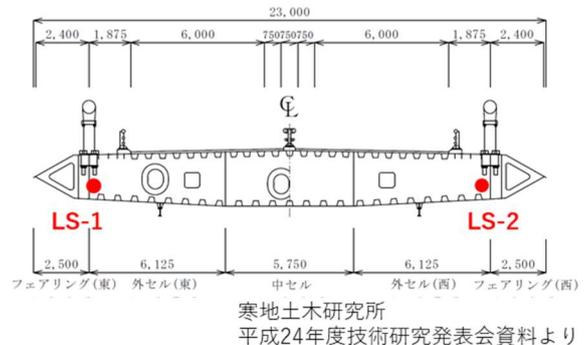
図-2 計測機器設置位置(中央部断面図)
