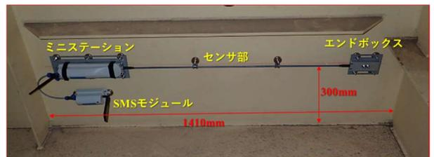
写真-1 計測機器設置状況
