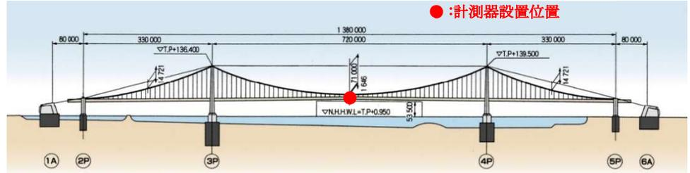
図-1 白鳥大橋の側面図(計測機器の設置位置)
