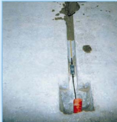
モルタル内部に設置された光学ストランド
