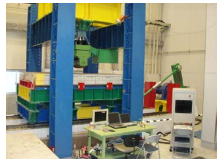
写真-1 架台移動式輪荷重走行試験機
